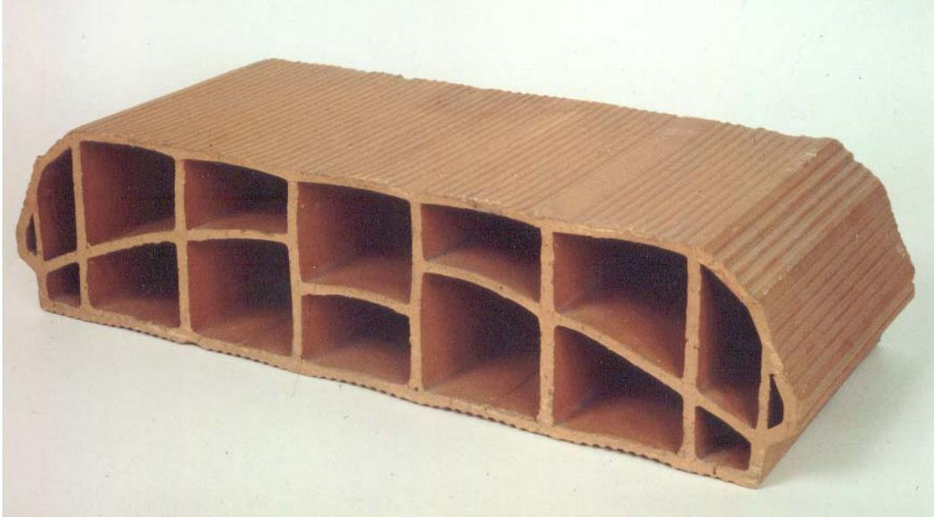
Hay que evitar, en el diseño del molde, los ángulos vivos en los tacos que forman las perforaciones, pues, "cortan" al barro y favorecen la formación de microfisuras interiores, tal como se representa en la figura 128.
