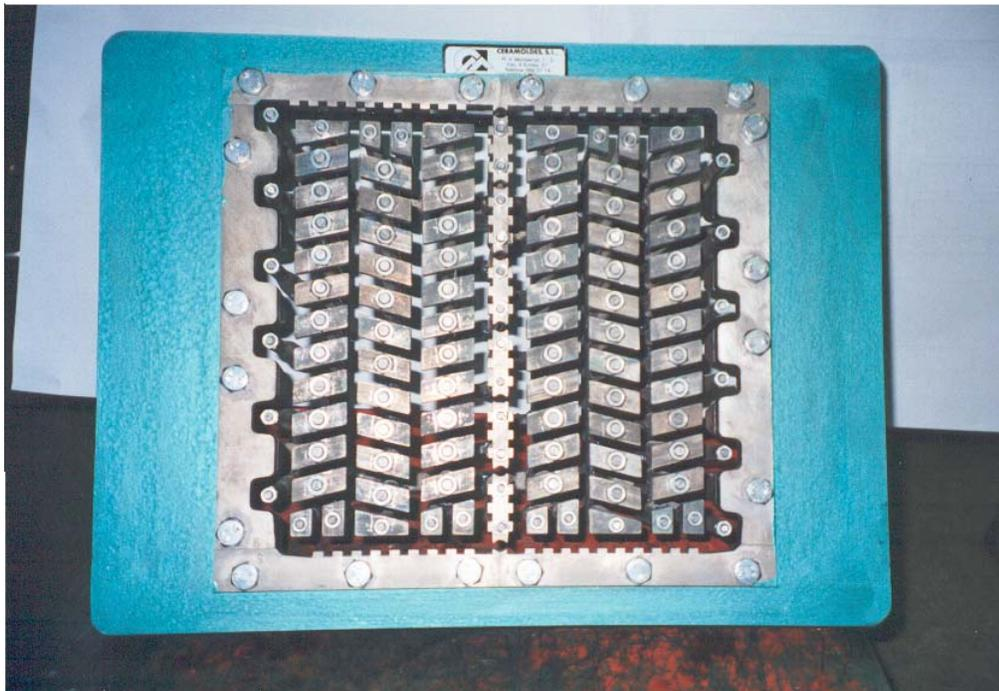
Eliminando el taco redondo que forma la perforación, se aumenta la sección de salida y se igualan velocidades, pero se incrementa el peso de la pieza y se retrasa el proceso de secado. La solución más aconsejable en este caso consistiría en lubricar el molde en dichos puntos.
