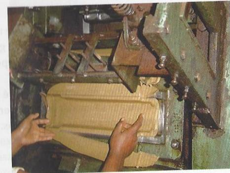
Processo de conformação obtido através de moldes metálicos ou de gesso, onde a massa pastosa recebe através de compressão formato desejado.
