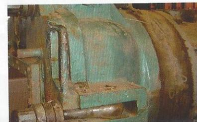
O desenho abaixo mostra a movimentação realizada no processo de extrusão, nota-se que a massa encontra barreiras ao sair na boquilha, elevando assim a amperagem da máquina e o desgaste da ponteira. No processo a massa caminha para a boquilha e chegando ao embudo a mesma é retida através das laterais onde é formada a zona morta.
